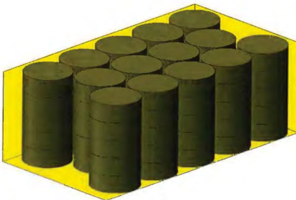
Abbildung 3-6: Beladung eines KC mit Pelletsäulen (beispielhafte Darstellung)
